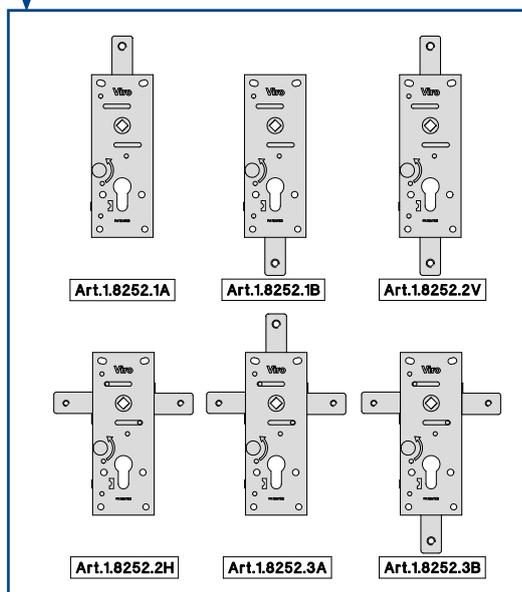
Fori di fissaggio asolati per la massima intercambiabilità con praticamente tutti i modelli in commercio.
