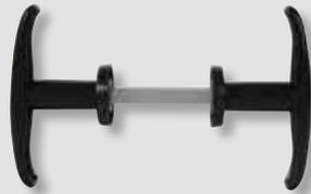
Coppie di maniglie di presa con quadro di 8 mm per montaggio su basculanti di spessore fino a 15 mm (art.8217.0600) o da 16 fino a 40 mm (art.8217.0600.4).
