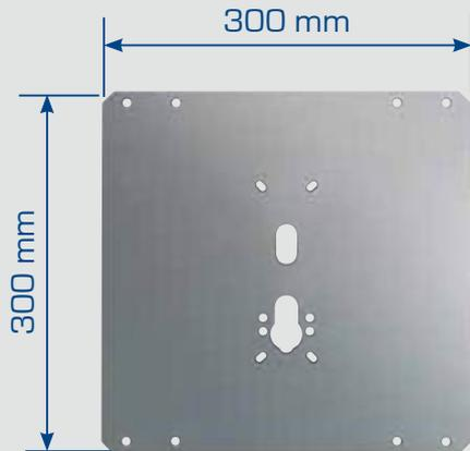
Piastra interna di protezione di spessore 2 mm, in acciaio cementato, temprato e zincato, adatta a tutti i tipi di serrature per basculanti in commercio, sia a cilindro europeo, che a cilindro tondo.
