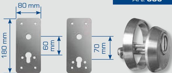
Rosetta di sicurezza in acciaio carbonitrurato e zincato, con piastrina rotante in acciaio cementato, temprato, ramato, nichelato e cromato, contro lo scasso ed il trapano (con regolabilità di 5 mm per adattarsi alla sporgenza del cilindro). Ghiera in acciaio zincato.
