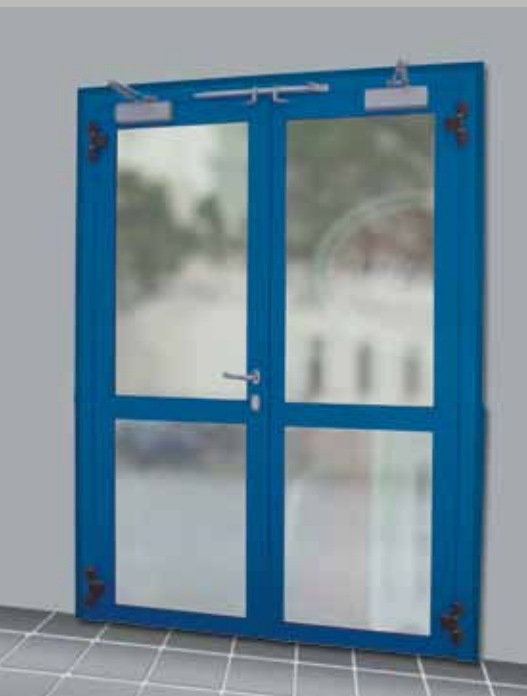
Vista interna vetrata tagliafuoco in acciaio a due ante, verniciata Ral 5010, con doppio chiudiporta aereo e regolatore di chiusura che garantisce la giusta sequenza di chiusura delle ante.
