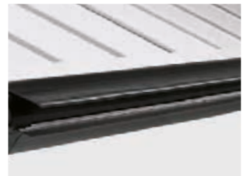
La zoccolatura inferiore in abs, di colore nero, ha una altezza di 50 mm, tappi laterali di chiusura e un profilo di alluminio all'interno. Il risultato estetico pregevole garantisce anche una perfetta chiusura tra anta mobile e pavimento. Optional.
