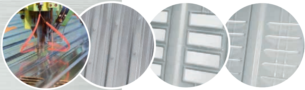
Zink GT: l'unione delle lamiere d'acciaio avviene attraverso giunti temprati.
