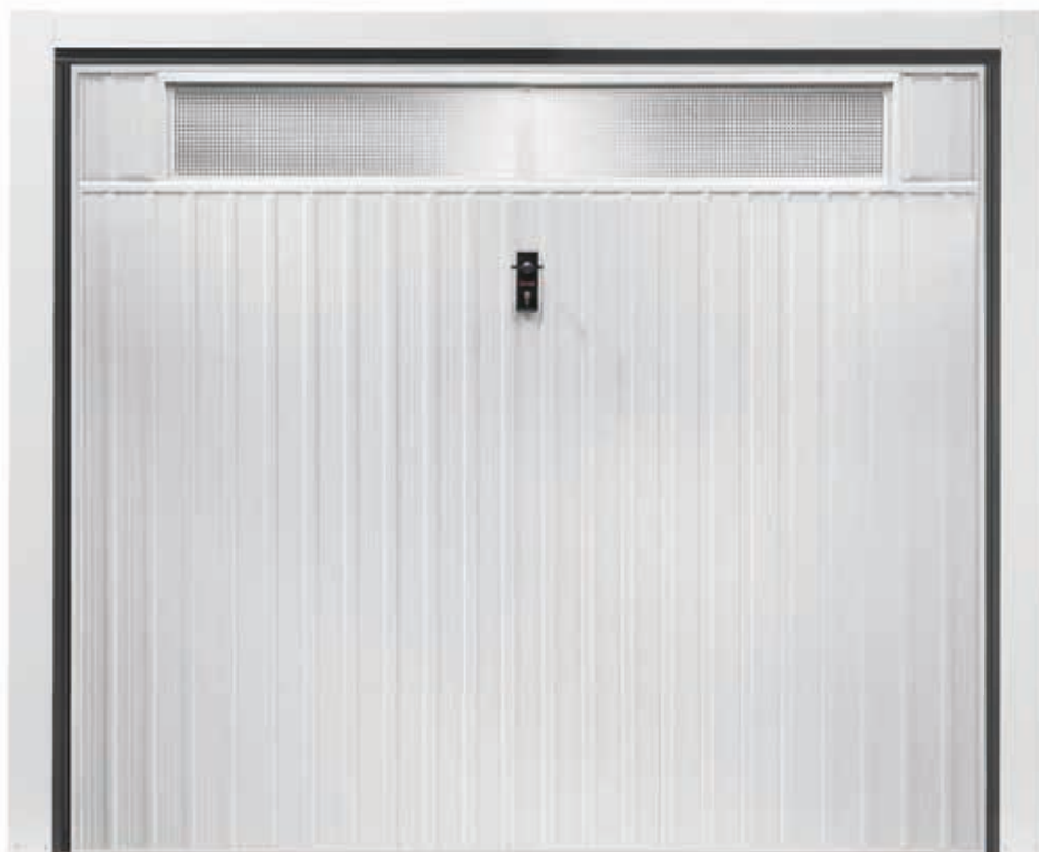
Porta basculante Zink Sikura HF con sopraluce incorporato nell'anta mobile con 2 specchiature in lamiera forata (fori quadri 8x8 mm) con predisposizione per motori laterali, tinta Primer per interni Ral 9010.
